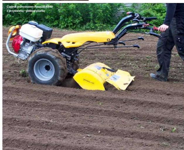
Ciągnik jednoosiowy Pasquali XB40 z przystawką - filcogryzarką
