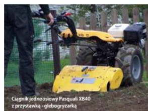
Ciągnik jednoosiowy Pasquali XB40 z przystawką - glebogryzarką
